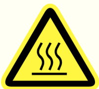
Heet oppervlak Surface chaude
