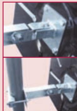
Livrée avec chaque miroir antigivre/antibuée, fixation universelle en acier galvanisé pour murs et poteaux ronds (Ø 76 à 90 mm) ou rectangulaires (60x80 ou 80x80 mm).
