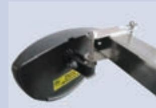
Fixation fournie avec chaque rétroviseur. Facile à monter sans perçage : fixation par platine s'adaptant sur la majorité des engins.
