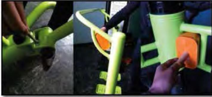
*Contrôle d'absence de risques de coincement de tête et de doigt sur les appareils FreeTness.*
